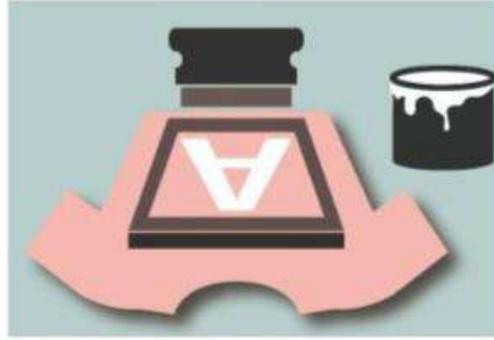
Pour le procédé, c'est assez simple : l'encre est déposée sur le textile, grâce à un écran ajouré, comme un “pochoir”. Le textile absorbe l'encre à travers les trous du pochoir, ce qui permet aux couleurs de s'imprégner durablement. Ensuite, l'encre est polymérisée grâce à des infrarouges, pour fixer encore plus efficacement les motifs.
