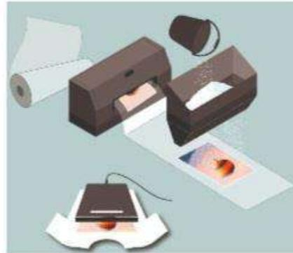
Pour réaliser une **impression en Direct to Film**, le visuel est **imprimé** sur un film en PET, puis **saupoudré** d'une poudre thermo-fusible (composée de silicone) : une fois **chauffée**, cette poudre va fondre, et c'est ce qui permettra au motif **d'adhérer** au support final. Et justement, la dernière étape, c'est de récupérer le visuel préparé avec la poudre, pour le **presser à chaud** et le déposer sur un t-shirt, un polo, un sac et même des chaussettes !
